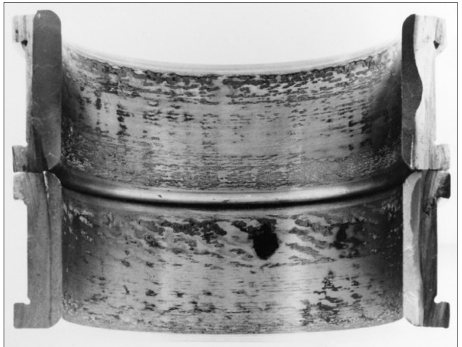
13: 베어링 장착이 너무 느슨하여 원통롤러 베어링 내륜 내경에 발생된 프레팅 부식
