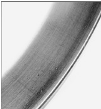
23: 정상궤적, 육안관찰이 가능한 표면 구조, 단지 이물질에 의한 작은 압흔 현상
