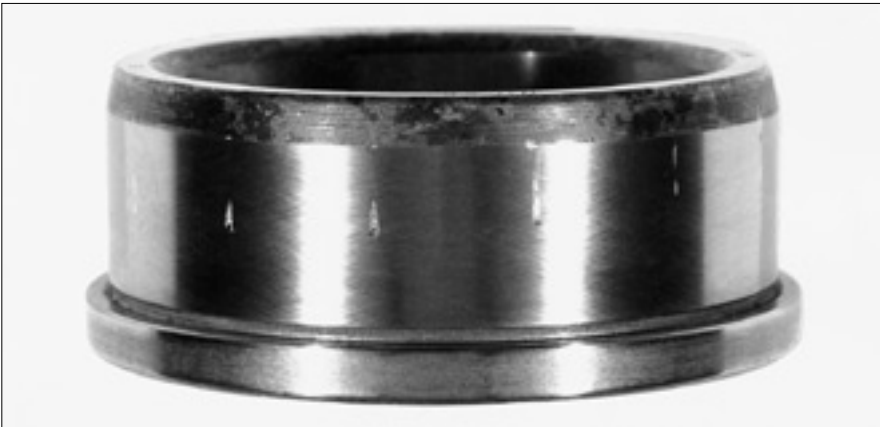
76: 롤러 전동체 세트에 조립시 기울어져서 발생된 원통 롤러 베어링 내륜 궤도면의 스코어 마크
