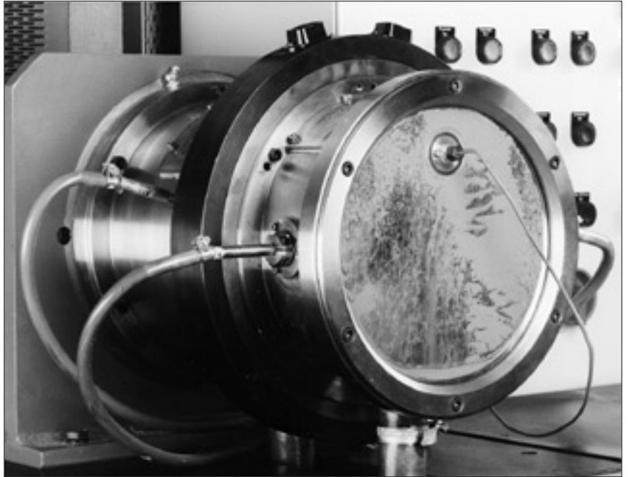
114: 구름베어링 밀봉의 효과를 검사하기 위한 시험 장비
