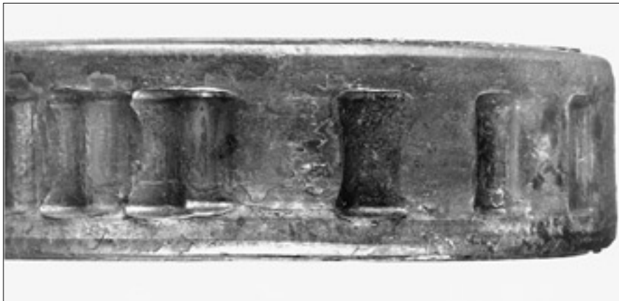
77: 원통 롤러 베어링의 궤도면에 롤러에 의해 아주 심하게 나타난 타붙음 및 과열 흔적
