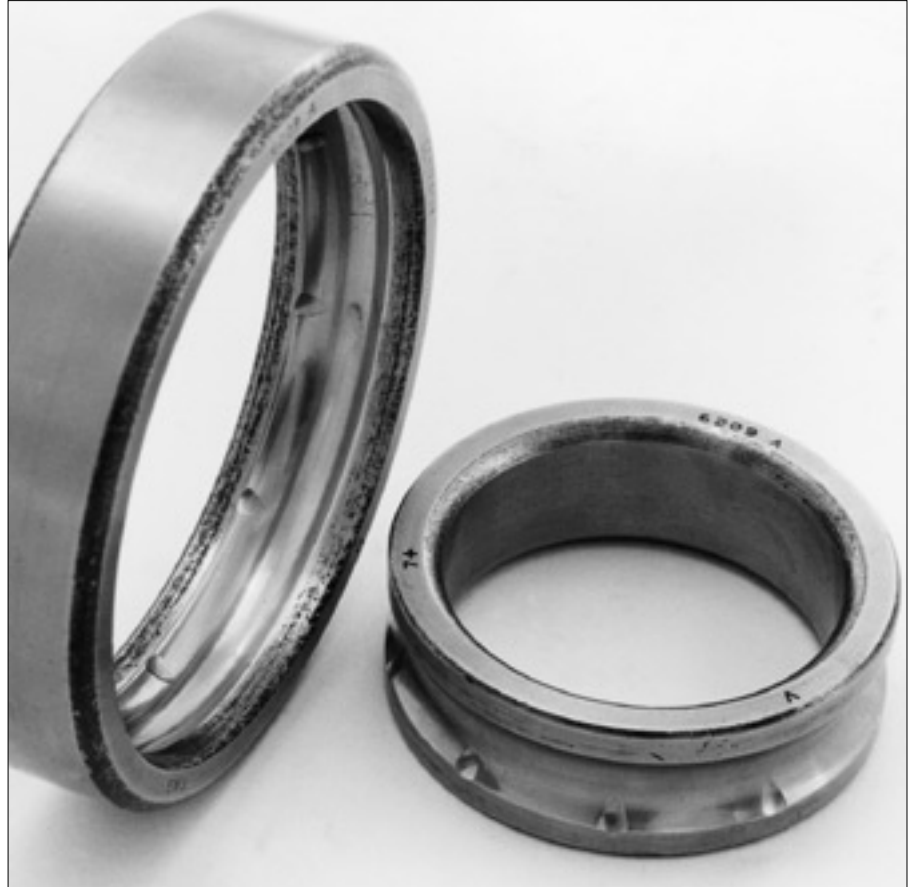
58: 깊은 홈 볼 베어링의 궤도 턱경 부분 볼 압흔. 베어링 조립 장비가 헐거움 끼어맞춤 할때 링에 붙어서 그 힘이 전동체를 통해 전달
