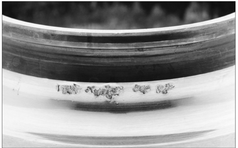
46: 부적절한 예압 조정에 의한 앵귤러 콘택트 볼 베어링의 궤도 밑부분의 피로 손상
