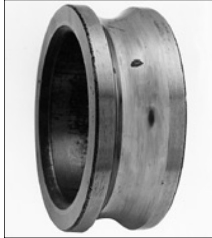
41: 깊은홈 볼 베어링 내륜 궤도면의 흠집에 의하여 인정될 수 있는 전형적인 피로 현상손상이 진전되면 재료는 완전히 박리된다.
